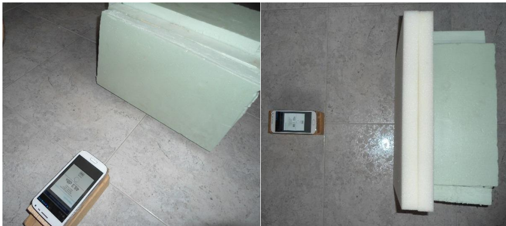
Fig. 4.3.10: montaje de los elementos con las láminas (tapas) de por medio.
