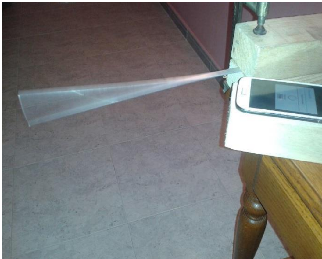
Fig. 4.2.8: Varilla vibrando en el proceso de captación de datos experimentales
