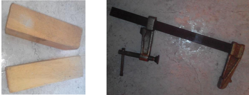
Fig. 4.2.6: Tacos de madera y sargenta para sujeción de las varillas
