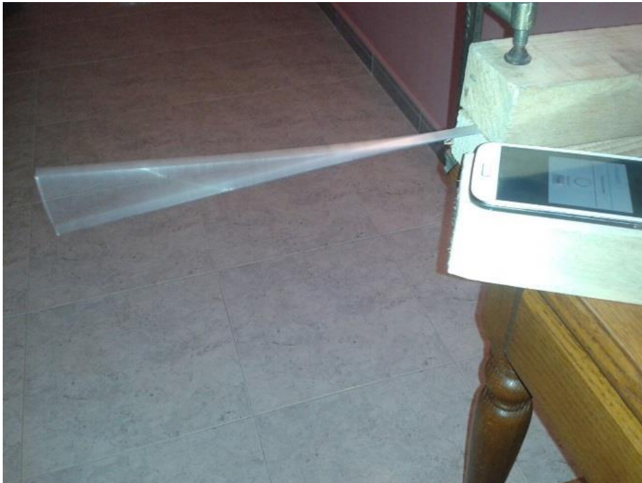
Fig. 1.1: Varilla vibrando en el proceso de captación de datos experimentales.
