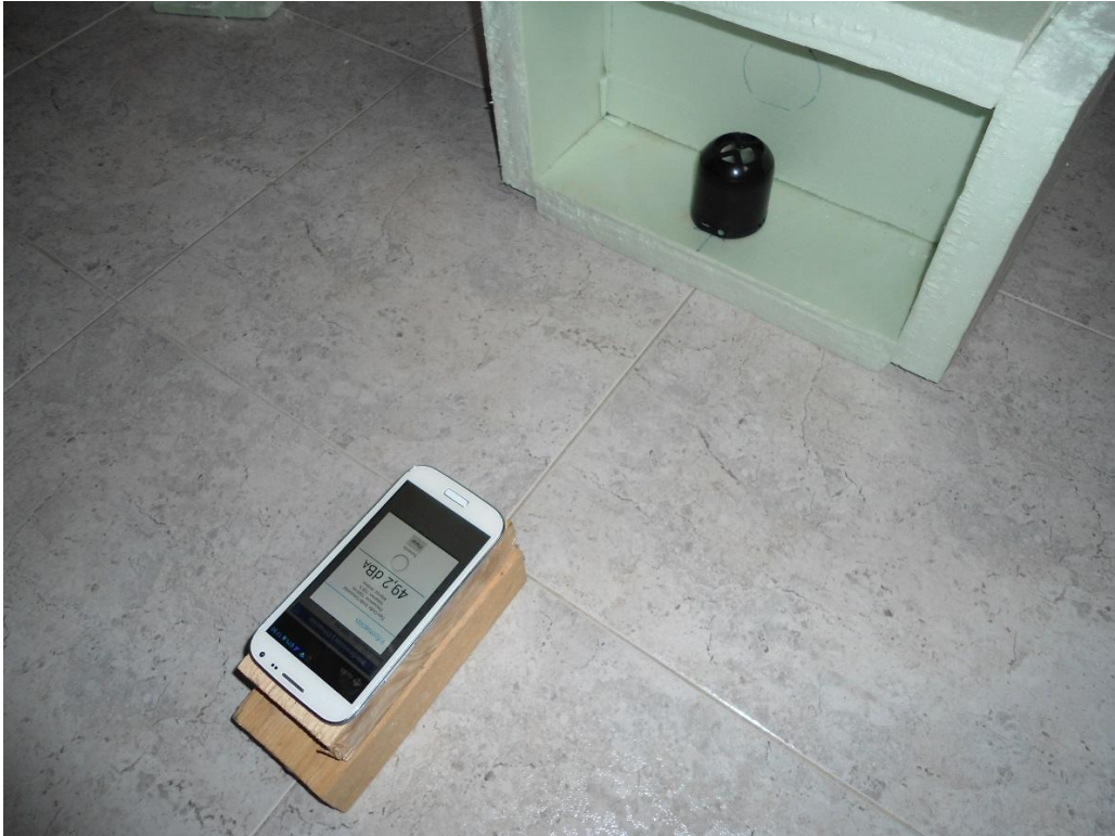
Fig. 4.3.9: posición de los diferentes elementos en la toma de datos sin láminas (tapas) de por medio.
