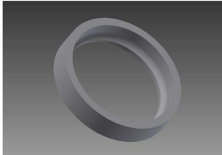
Figura 4.6. Pista exterior de los rodamientos.
