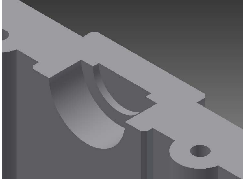
Figura 4.19. Detalle del alojamiento para los rodamientos del eje intermedio en la tapa.
