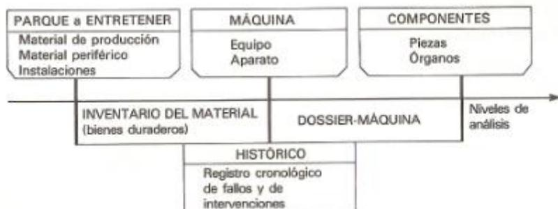
Figura 3.9. Esquema de la descomposición de un equipo complejo. [15]
