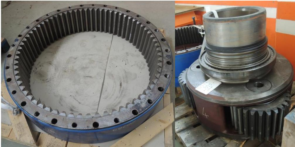
Figura 2.10. Corona, eje Porta-satélites y satélites de caja multiplicadora de aerogenerador NM 48/750.
