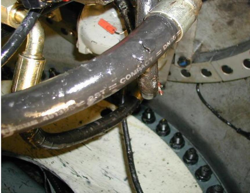
Figura 4.2. Manguera degradada. Fuente: [21]
