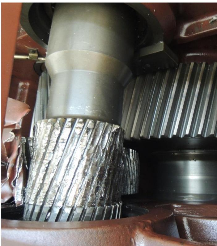
**Figura 4.3.** Degradación y aplastamiento de ruedas dentadas de una caja multiplicadora del aerogenerador NM 48/750.
