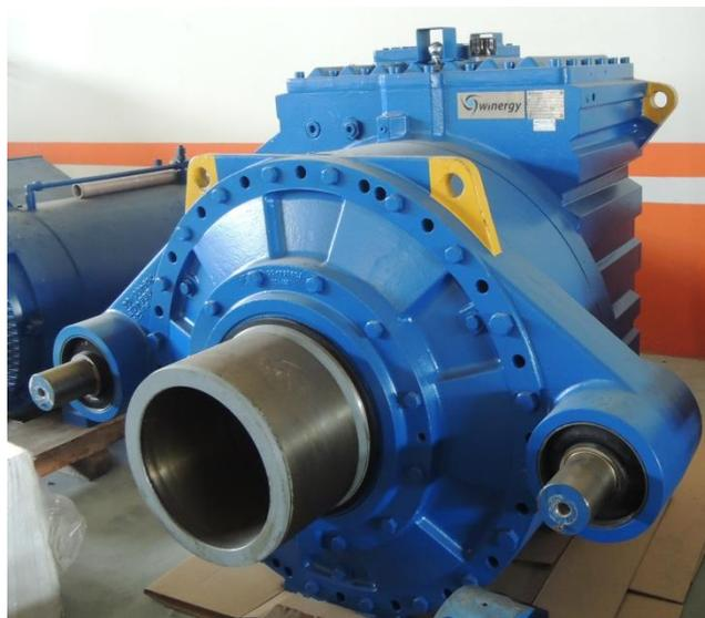
Figura 2.8. Caja multiplicadora de aerogenerador Negmicon.
