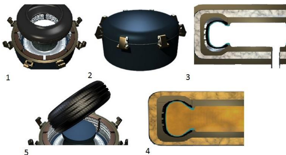
Ilustración 2.3 Fases de la cocción de un neumático de turismo. Fuente: Página web Michelin
