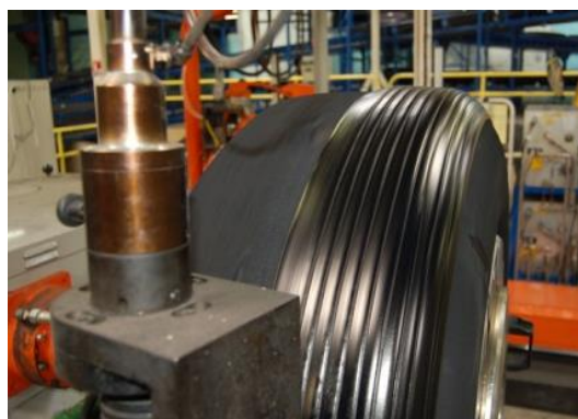
Ilustración 1.21 Puesta de la banda de rodadura sobre la carcasa. Fuente: www.circulaseguro.com/
