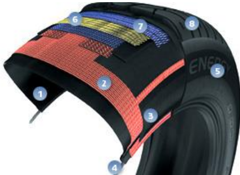
Ilustración 1.11 Partes del neumático Michelin. Fuente: página web de Michelin.
