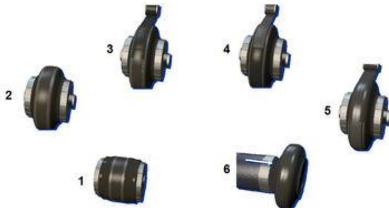
Ilustración 2.2 Fases de la terminación de un neumático de turismo. Fuente: Página web Michelin
