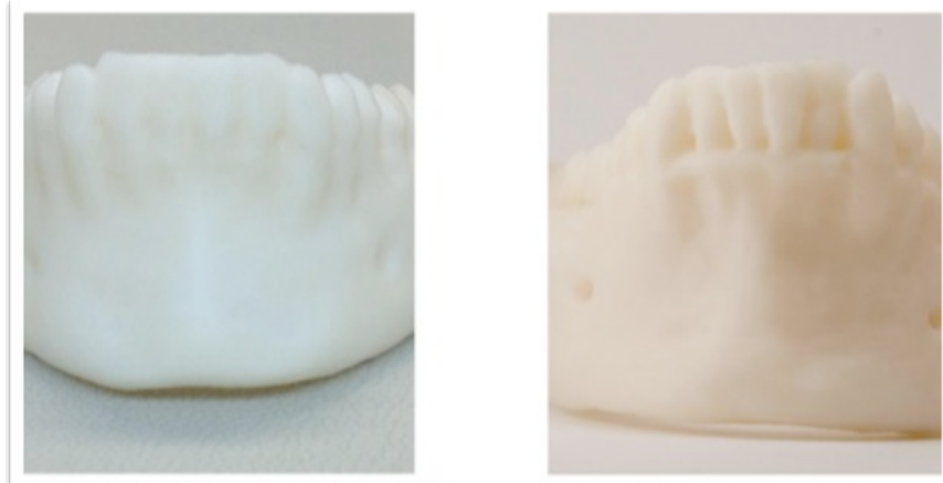
Figura 2.4.- Izquierda: Foto de un modelo hecho con un espesor grande: no hay detalles dentarios. Es imposible reconocer los elementos anatómicos. Derecha: modelo hecho con un valor de espesor adecuado. Los elementos anatómicos se reconocen [2]
