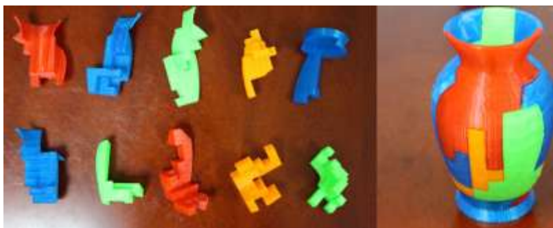
Figura 3.30. Partes de enclavamiento impresas en 3D (izquierda) y el objeto ensamblado correspondiente (a la derecha).
