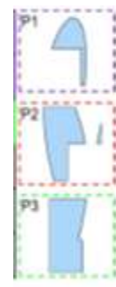
Figura 3.6 Piezas 3D delgadas y desconectadas (en morado y rojo(P1 y P2)); en lugar de estructuralmente estrechas, piezas 3D (en verde (P3))
