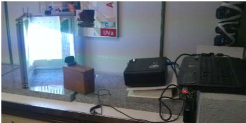
Figura 4.15 Instalación para calibración de la cámara
