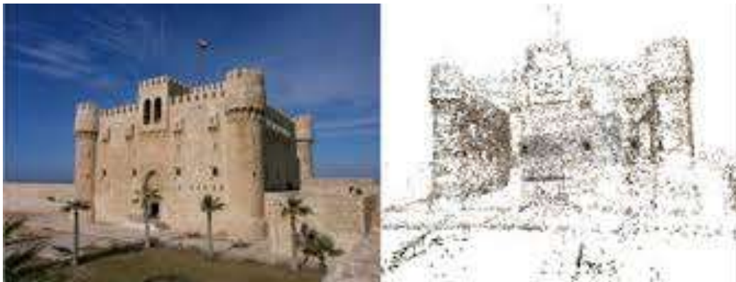
Figura 3.38 Nube de puntos a partir de una fotografía
