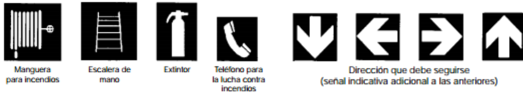
Figura Anexo 3.4: Señales relativas a los equipos de lucha contra incendios
