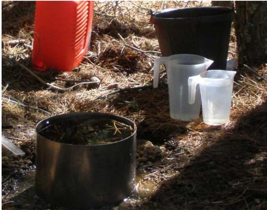
**Figura 17. Infiltrómetro y jarras utilizadas para su llenado.**
