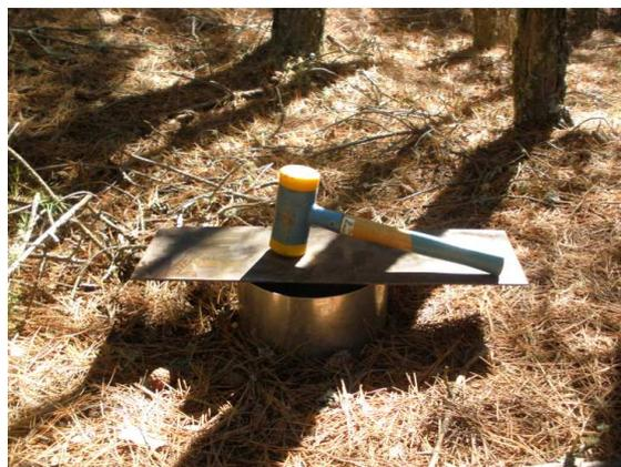
**Figura 15. Infiltrómetro recién clavado y material utilizado en la operación.**
