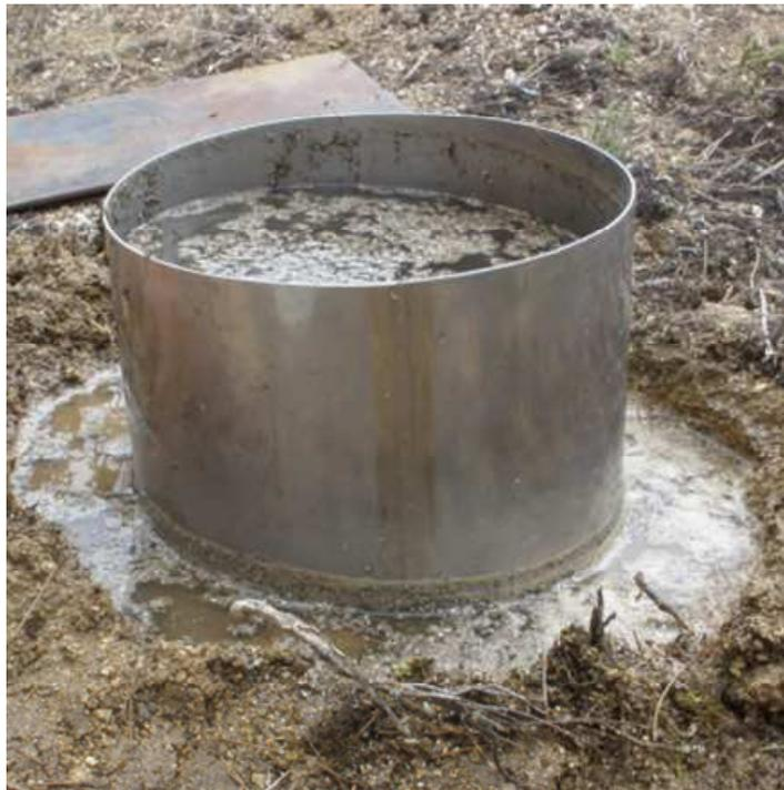
**Figura 14. Infiltrómetro de cilindro con foso alrededor imitando el efecto del doble cilindro.**
