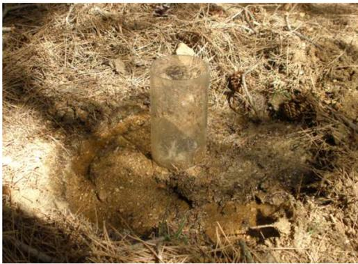
Figura 9. Infiltrómetro de metacrilato en el ensayo piloto.
