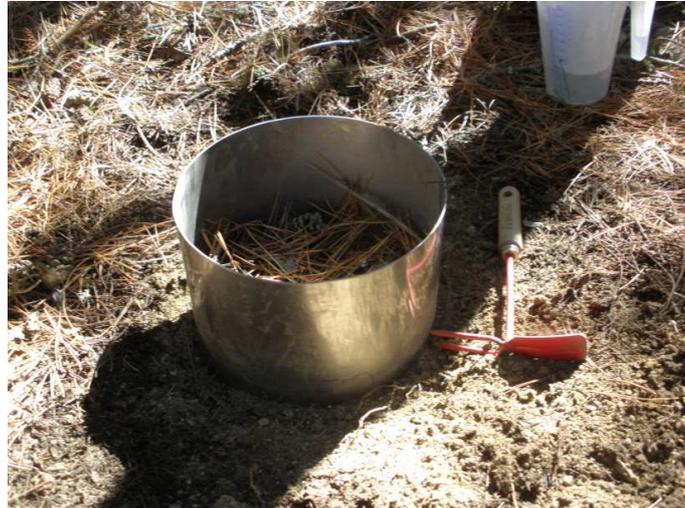
**Figura 16. Foso realizado para imitar el doble anillo y azadilla utilizada.**
