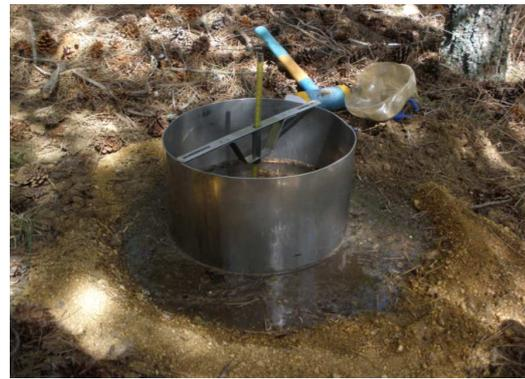
Figura 10. Infiltrómetro de acero con flotador.
