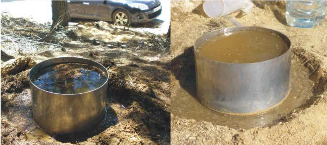
Figura 66: Izquierda: ensayo de infiltración en zona arbolada. Derecha: ensayo de infiltración en zona degradada. Puede observarse la diferencia de turbidez en el agua durante los ensayos.
