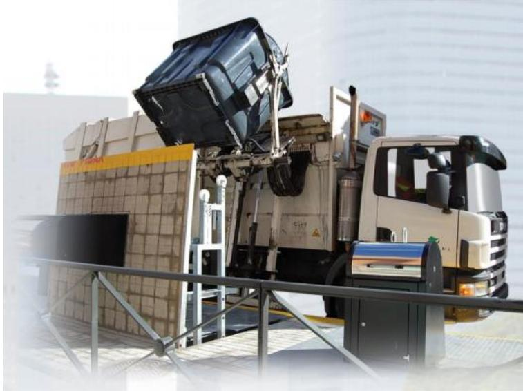
Figura 2.1. Descarga lateral de contenedor por un lateral del camión. (Fuente: Contenur)
