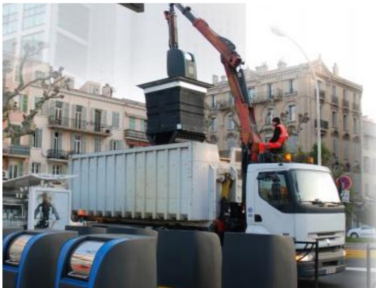
Figura 2.3. Contenedor de descarga por la parte inferior. (Fuente: Contenur).
