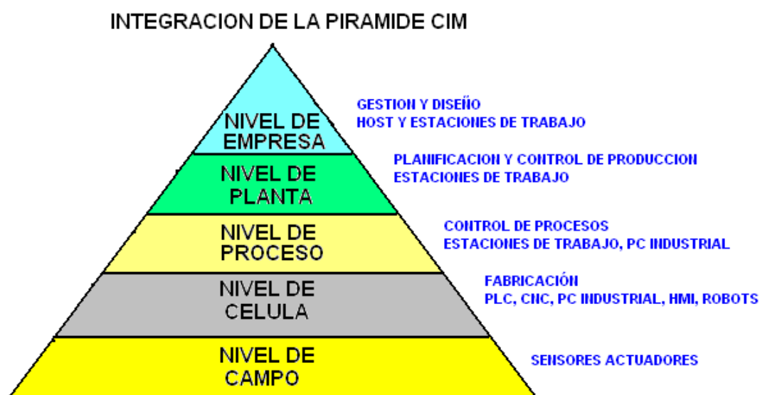
Figura 3.8: Niveles de integración de la pirámide CIM
