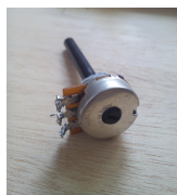
Figura 9.17: Ejemplar de un potenciómetro como los empleados en el montaje.
