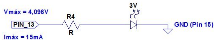
Figura 9.27: Esquema eléctrico que instalaremos, en las salidas analógicas, sin valores determinados.
