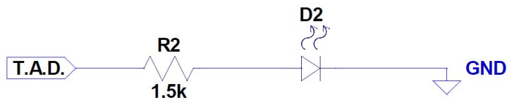
Figura 9.32: Esquema eléctrico de las salidas digitales con los valores finales.
