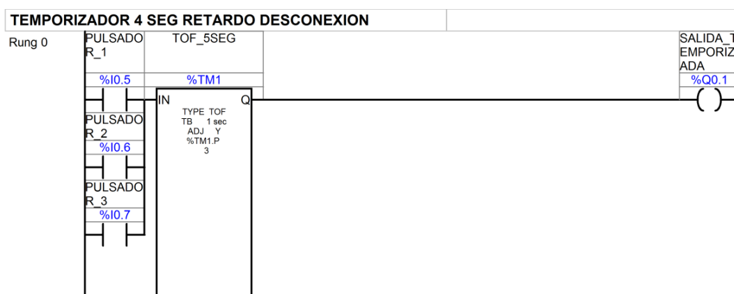
Figura 4.9: Ejemplo de un sistema temporizado con retardo a la desconexión de una de las entradas digitales: %I0.5, %I0.6 o %I0.7.
