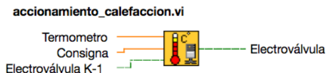
Figura 8.7: Icono y conectores de accionamiento_calefaccion.vi .
