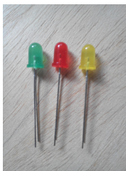
Figura 9.18: Ejemplares de los diodos utilizados para representar mostrar el funcionamiento de las señales de salida..
