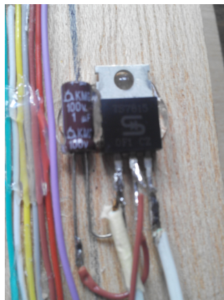
Figura 9.21: Regular de tensión ya conectado.
