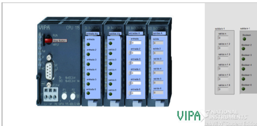
Figura 5.8: Panel frontal del emulador de PLC.
