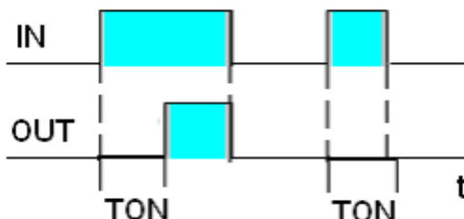
Figura 6.3: Gráfica de las señales de entrada y salida de un temporizador TON.
