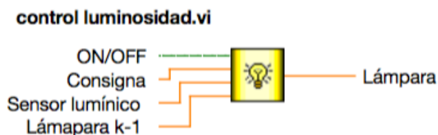
Figura 8.1: Icono y conectores de control_luminosidad.vi .
