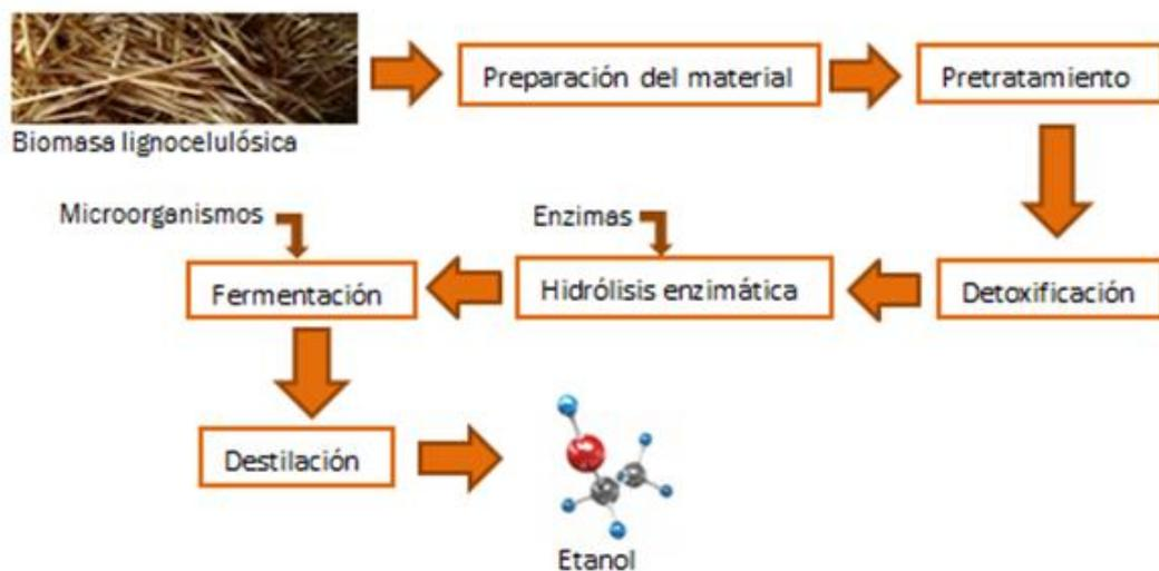
*Figura 1.8. Esquema general del proceso de producción de etanol vía enzimática.*
