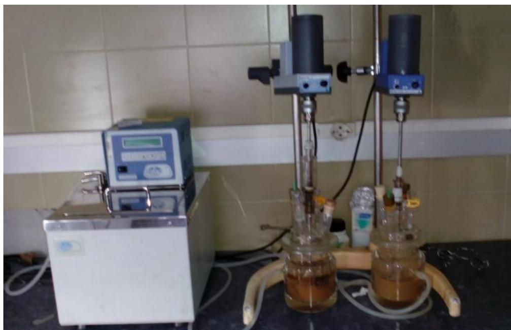
*Figura 3.10. Equipo de hidrólisis enzimática en reactores encamisados con agitación mecánica*
