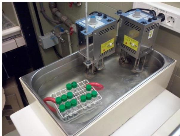
*Figura 7.3. Tubos para pruebas de fenólicos en baño termostado.*
