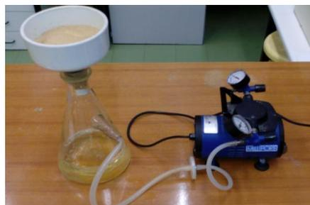
**Figura 3.6.** Filtrado de paja de trigo posterior al lavado.
