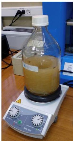
**Figura 3.5.** Proceso de lavado de la paja de trigo pretratada
