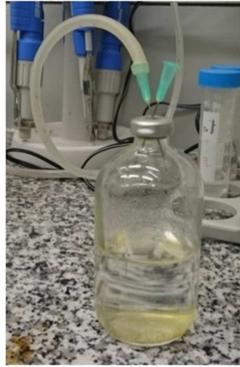
Figura 8 Método utilizado para extraer el oxígeno.
