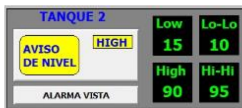
Ilustración 4.25: Alarma de nivel alto tanque 2.
