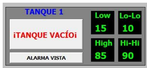
Ilustración 4.24: Alarma Tanque vacío.
