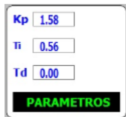
Ilustración 4.18: Sintonía PI -> Estabilidad de la bomba.
