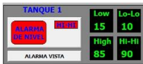
Ilustración 4.26: Alarma de nivel muy alto tanque 1.
