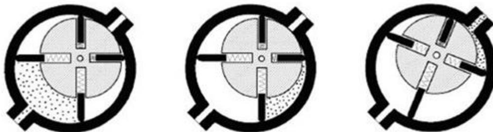
Fig. 2.10. Funcionamiento de un compresor rotativo. [W3]
