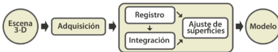
Figura 2.4: Etapas del proceso de reconstrucción 3D (Branch 2007).
