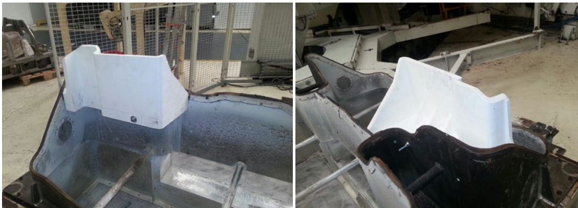
Figura 5.73: Prototipo de la pieza correspondiente al lado de la guantera montado sobre la cuba.
