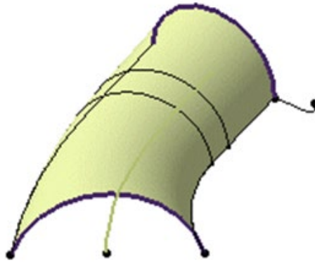
Superficie de múltiples secciones definida por 2 secciones planas y 2 curvas guía
