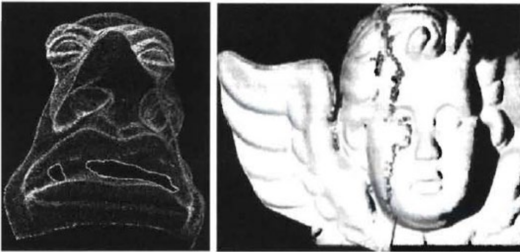
Figura 2.6: Anomalías topológicas sobre la superficie. Huecos generados por oclusión (a la izquierda). Anomalía causada por redundancia de datos (a la derecha) (Branch 2007).
