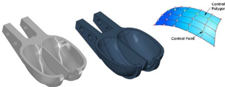
Figura 2.13: Modelo sólido y modelo CAD 3D de una pala de una turbina Pelton (Arbeláez, 2012)
