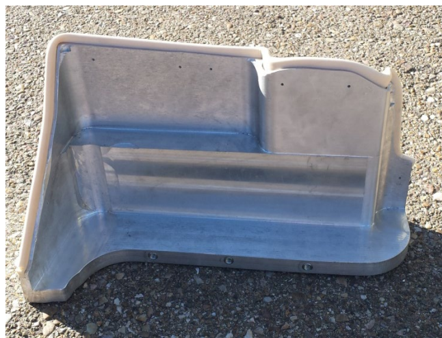
Figura 5.74: Pieza correspondiente al lado de la guantera mecanizada en aluminio.
