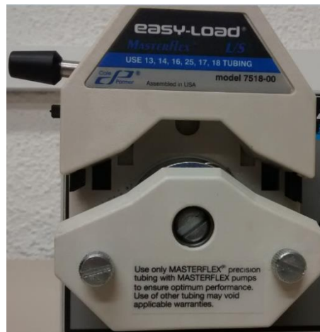
Figura 4.1.4: Cabezal de bomba peristáltica "Easy-Load (Masterflex)" FUENTE : http://shop.llg.de/info1947_Jang_DE.htm
