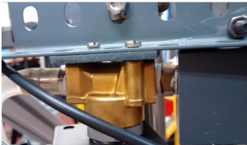
Figura 4.2.7: Unión electroválvula-acople -sensor de presión
