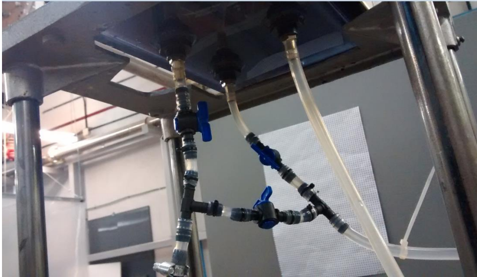
Figura 4.3.2: By-pass, (o) y (b), situado antes de la entrada (p) y después de la salida (a) del depósito (4)
