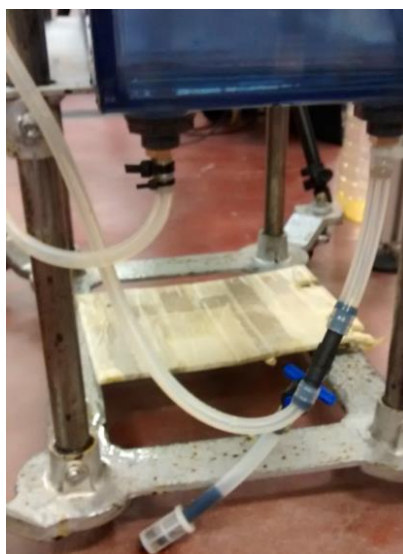
Figura 4.3.3: Válvula de descarga (t) con filtro a la salida (j) del depósito inferior (1)
