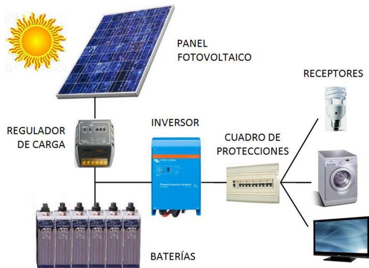
Figura 1.4. Instalación fotovoltaica aislada.
