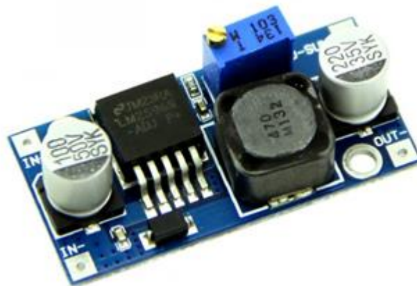
Figura 2.15. Placa convertora de 24 V a 5 V.
