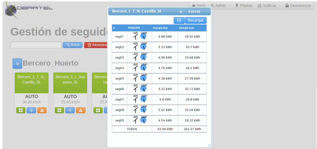
Figura 4.19. Posiciones y producciones serie seguidores.
