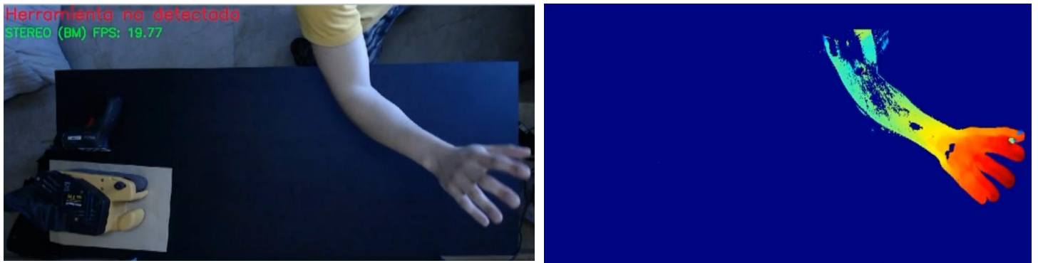
Figura 8. 11: (Izquierda) Imagen recibida. (Derecha) Mapa de profundidades segmentado a la acción principal.
