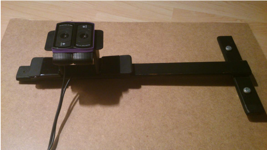
Figura 5. 6: Distribución final de las cámaras.
