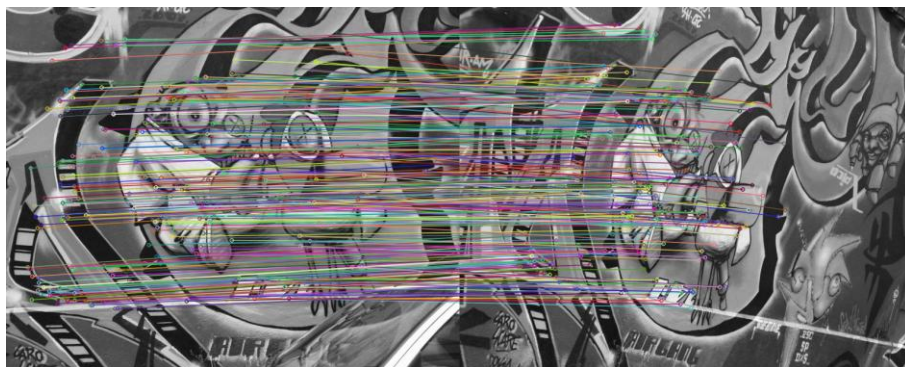
Figura 2. 26: Puntos equivalentes entre dos imágenes usando KAZE
