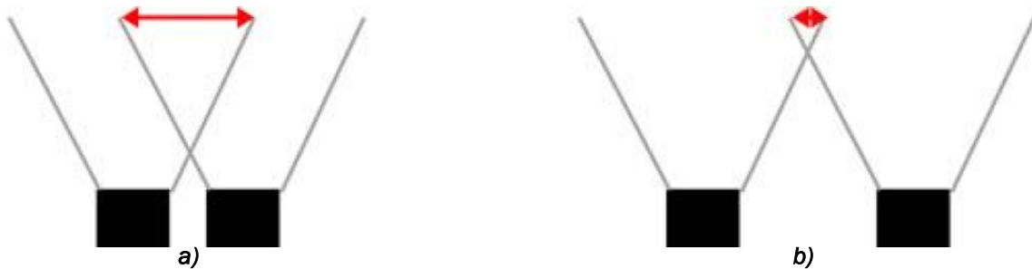
Figura 2. 9: a) Zona común de buen solapamiento. b) zona común con solapamiento escaso.
