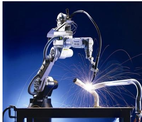
Figura 14. Robot de soldadura
