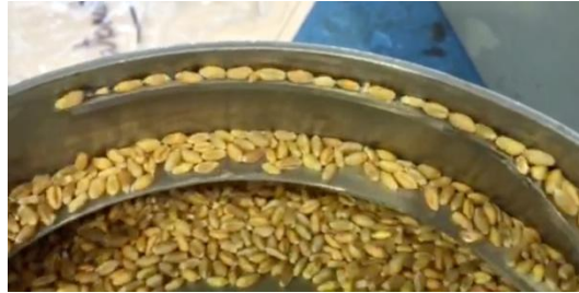
Figura 28. Detalle canal interior dosificador vibratorio
