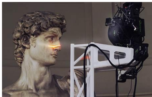
Figura 17. Escaneado 3D de una escultura
