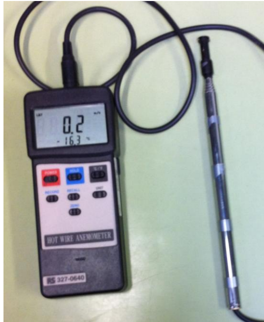
Figura 4.2. Fotografía del anemómetro RS 327-0640
