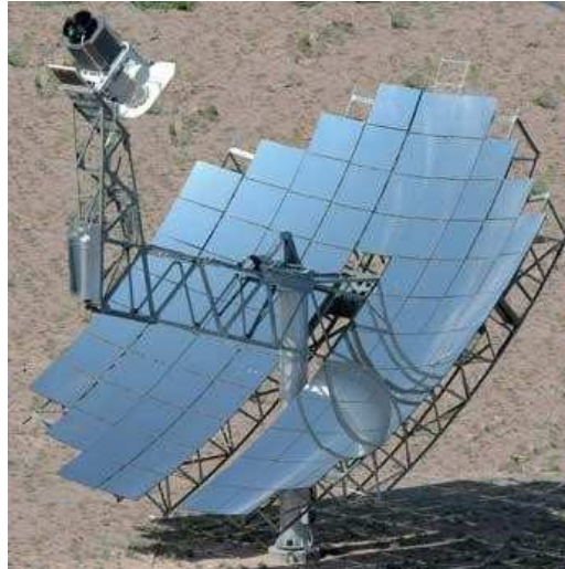
Figura 51: Disco parabólico con motor Stirling.
