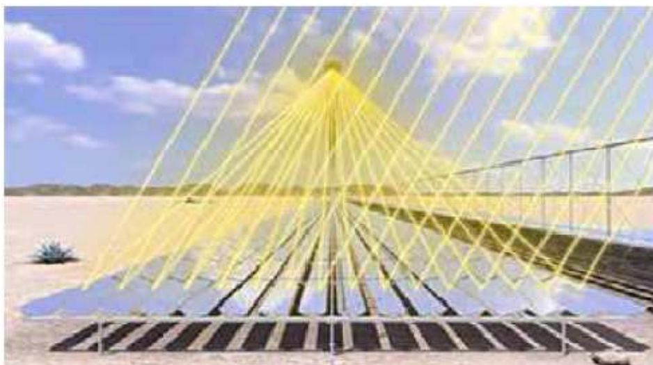
Figura 63: Esquema simplificado de la trayectoria de los rayos solares
