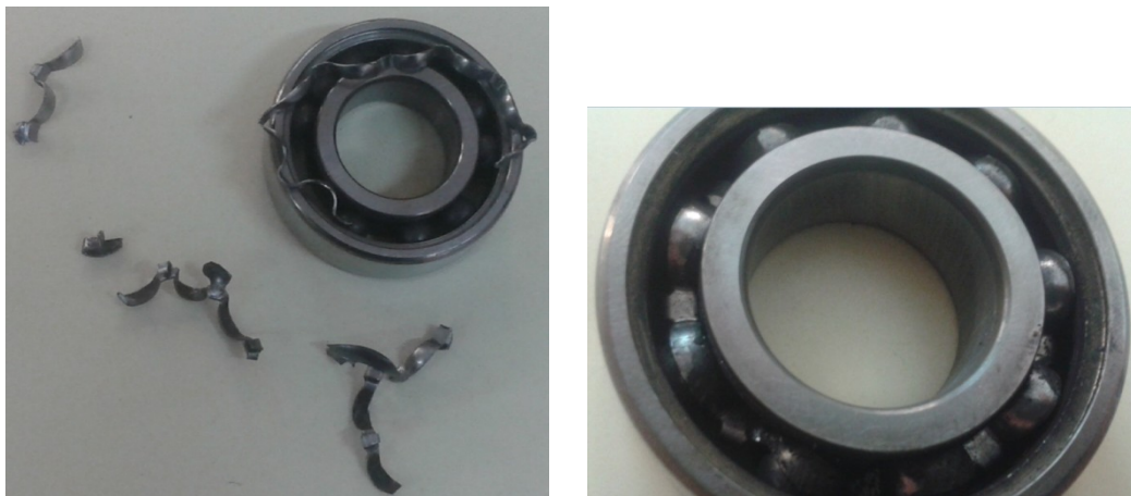
Figura 6.3 Rodamiento en un estado de fallo muy grave. [Departamento de ingeniería eléctrica de la Universidad de Valladolid].
