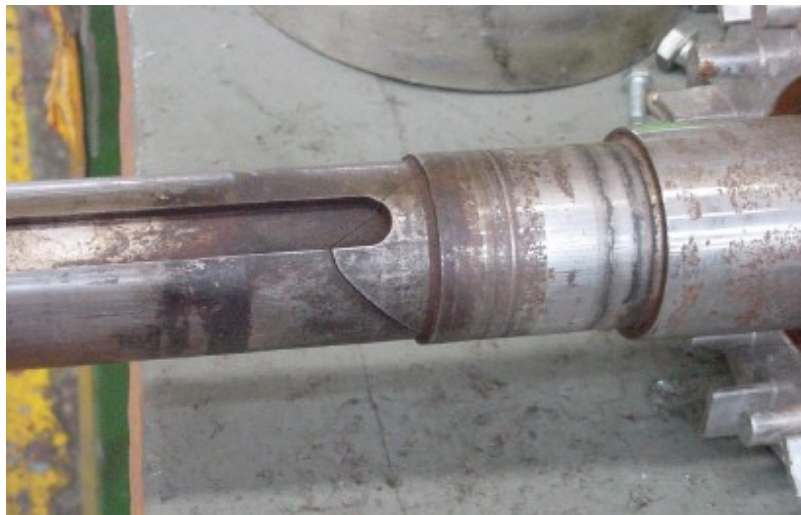
Figura 3.3 Rotura del eje de un motor eléctrico [5]
