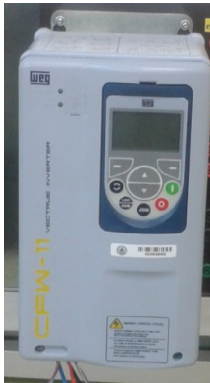
Figura A1.3 Variador de frecuencia WEG CFW-11.
