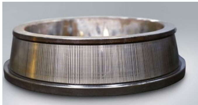
Figura 3.9 Rayado de la pista de un rodamiento debido al paso de corriente [15]
