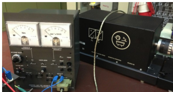
Figura A1.4 Freno de polvo magnético y unidad de control de Lucas-Nülle.
