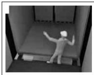
Figura 4. Existencia de huecos entre el muelle y el vehículo
