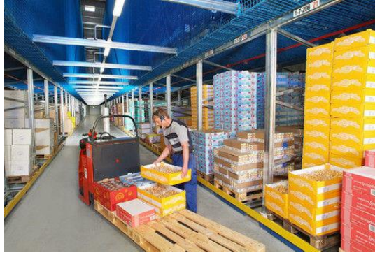
Figura 1.12 Operario realizando el picking en una máquina recogepedidos.
