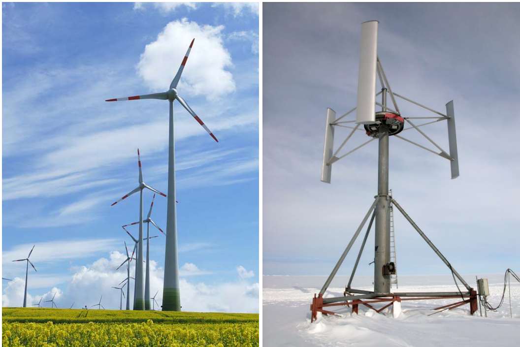
Figura 1.1 Turbina de eje horizontal (izquierda) y de eje vertical (derecha).
