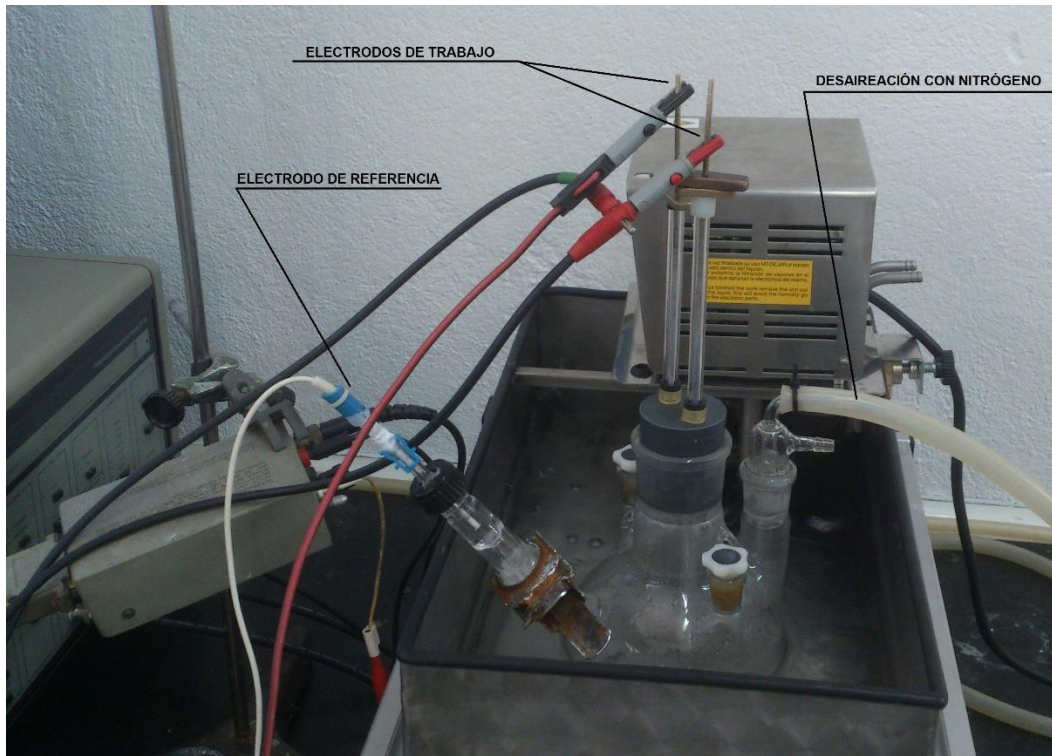
Figura 16. Montaje de la celda electroquímica
