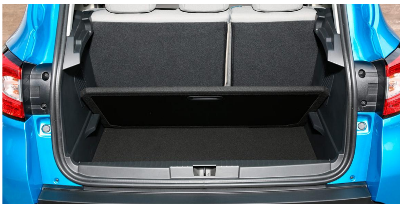
Ilustración 28. Maletero del Renault Captur con el doble fondo disponible para albergar depósitos
