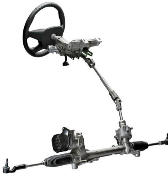
Figura 2.25. Dirección con asistencia eléctrica en la cremallera.
