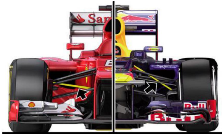
Figura 2.19. Suspensión tipo Pull-rod (izquierda) y Push-rod (derecha).
