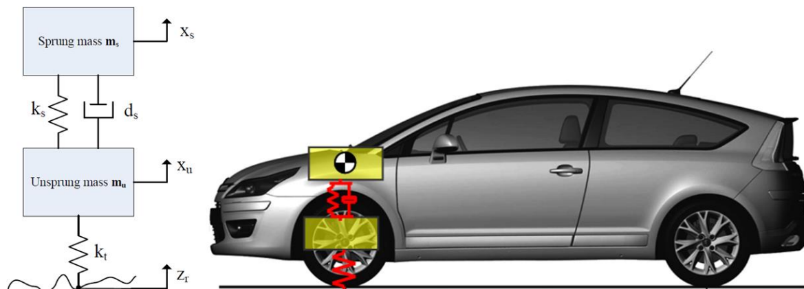
Figura 4.1. Modelo de un cuarto de vehículo.
