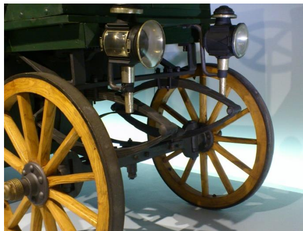
Figura 2.3. Suspensión delantera de ballestas del Daimler Motor-Lastwagen.
