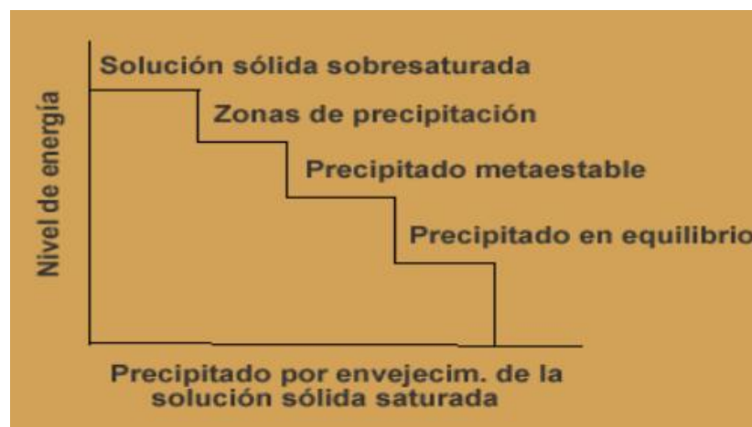
Figura 3.3. Niveles energéticos en función del precipitado de la solución sólida saturada
