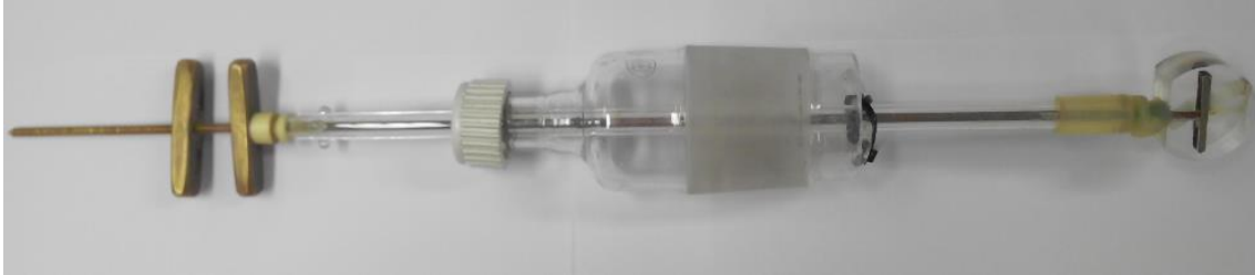
Imagen 4.13. Varilla roscada para acoplar la probeta
