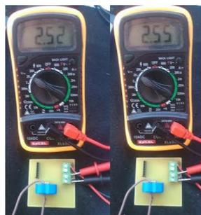
*Imagen 85 Sensor de corriente: Tensión de salida.*
