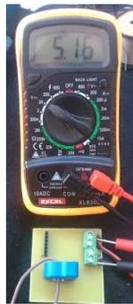
*Imagen 84 Corriente/presión: Comprobación de alimentación*
