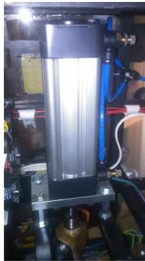
*Imagen 76 Cilindro neumático instalado*
