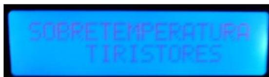
*Imagen 92 Pantalla LCD: Sobretemperatura en tiristores*
