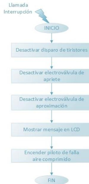
Imagen 33 Diagrama de flujo. Fallo aire comprimido
