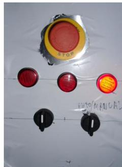
*Imagen 96 Piloto de sobretemperatura en los tiristores*
