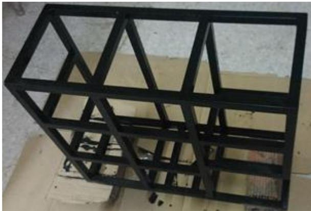
*Imagen 57 Aspecto final del chasis fabricado*
