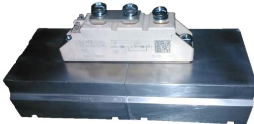
*Imagen 70 Perspectiva radiador y módulo de tiristores*
