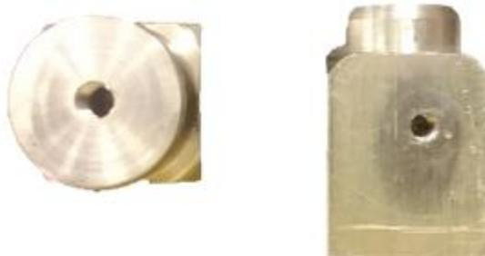
*Imagen 67 Portaelectrodos vista superior y lateral*
