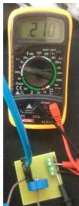
*Imagen 86 Sensor de presión: Tensión de salida.*
