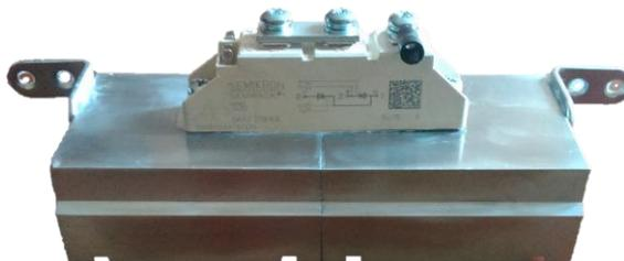
*Imagen 71 Alzado radiador y módulo de tiristores*
