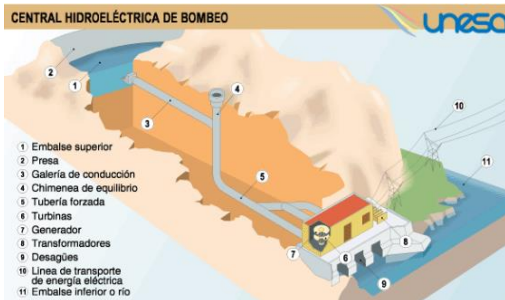
Imagen 20. Esquema de una central hidroeléctrica de bombeo.
