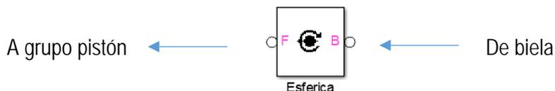
Fig. 43. Modelo SIMMECHANICS de la unión biela - grupo pistón
