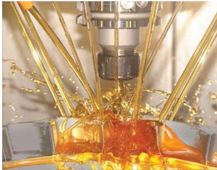
Imagen 15. Aplicación de fluido de corte por inundación [12].
