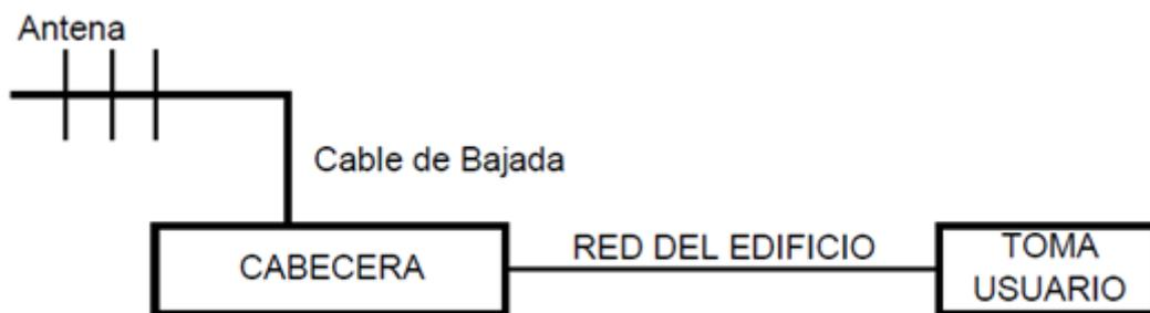
El cálculo de la potencia total de ruido incluye el ruido captado por la antena y el generado por el sistema equivalente del conjunto de los demás elementos. Este conjunto es el cuadripolo que tiene como factor de ruido ( $f_{\text{sis}}$ ), que es el factor de ruido del sistema a la entrada de la cabecera.
