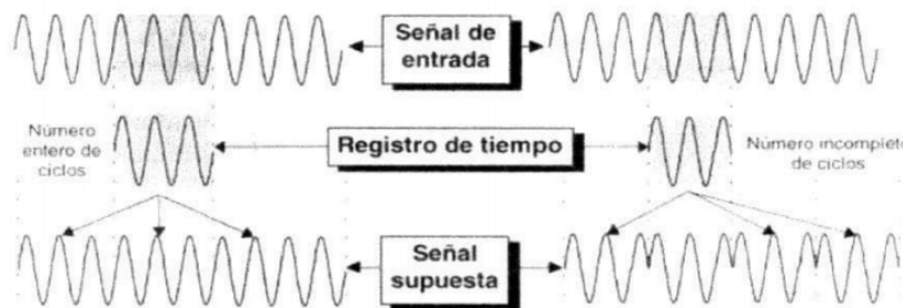
Figura 5.8 - Distorsión de la señal de entrada
