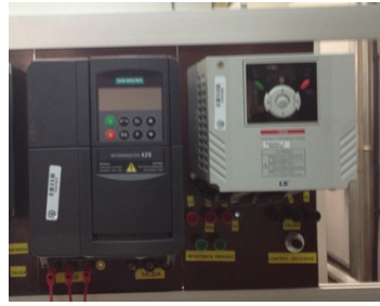
Figura 6.6 - Convertidor MicroMaster 420 de Siemens a la izquierda, y el convertidor LG Modelo SV-iG5A de LS a la derecha
