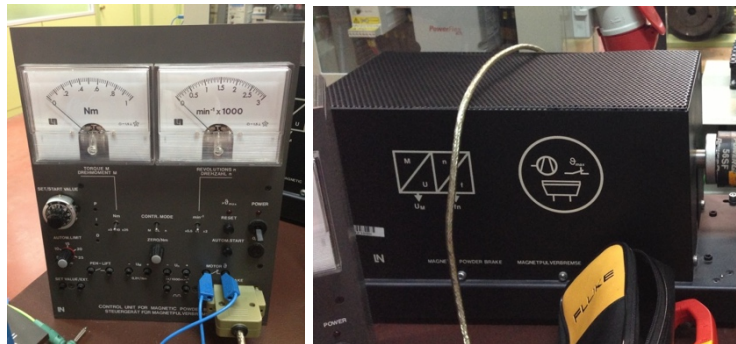
Figura 6.10 - Controlador de freno a la izquierda y freno de polvo magnético a la derecha
