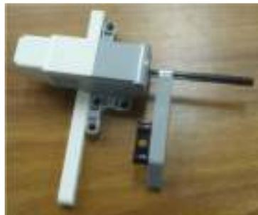
Ilustración 12. Motor barra excéntrica
