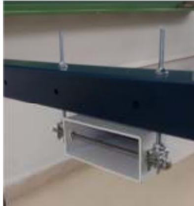
Ilustración 15. Detalle apoyo extremo de la viga
