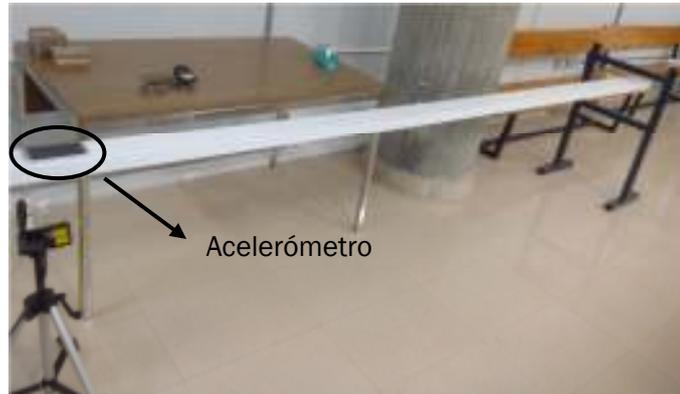
Ilustración 34. Detalle del acelerómetro en el centro de la estructura
