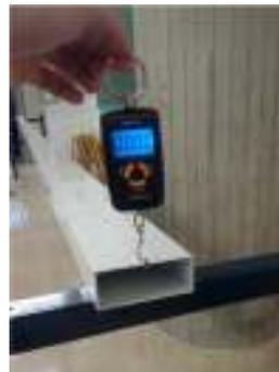
Ilustración 24. Detalle de la forma en la que se ha pesado la viga
