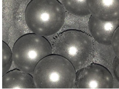
Ilustración 3.3 Detalle de las bolas de acero y el magnetismo todavía existente tras una fase de molienda, el cual pretendemos eliminar.
