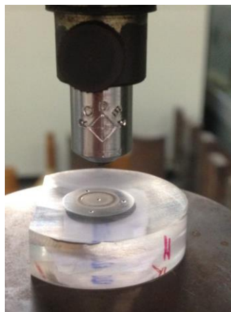
Ilustración 3.28 Detalle del penetrador empleado en la medida de la macrodureza y muestra del resultado en la probeta.
