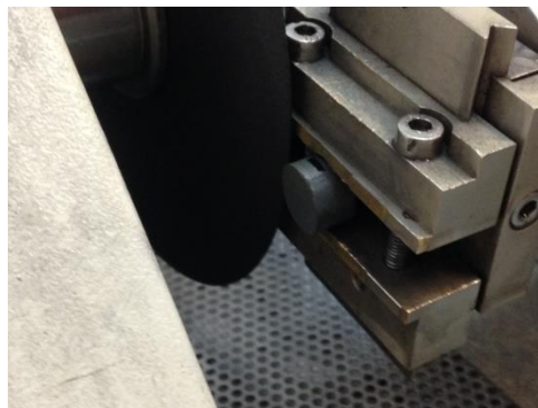
Ilustración 3.11 Detalle de la sujeción de la probeta en la tronzadora.
