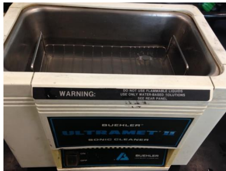
Ilustración 3.15 Izquierda: Equipo de limpieza mediante ultrasonidos. Derecha: Paños empleados en el pulido de las probetas.
