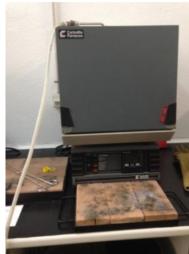
Ilustración 3.10 Horno en que se ha realizado el solubilizado con argón.
