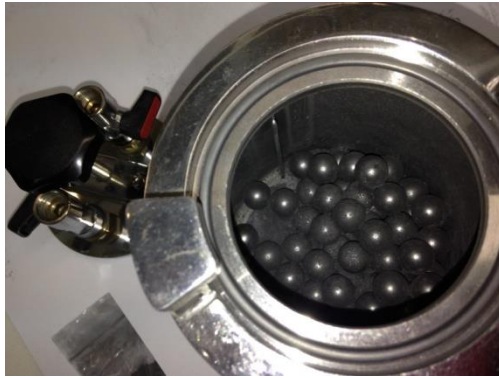
Ilustración 3.2 Detalle del cilindro en cuyo interior se aprecian los polvos a alear y las bolas de acero, así como la tapa y las válvulas de las que dispone.
