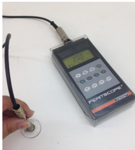
Ilustración 3.16 Muestra de la medida del porcentaje de ferrita de una probeta.
