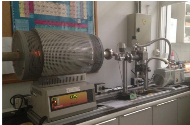
Ilustración 3.9 Proceso de sinterizado a 1175°C en atmósfera de vacío
