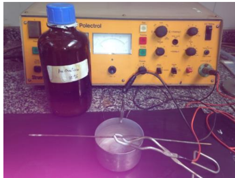
Ilustración 3.23 Material empleado para la realización del ataque electrofítico.
