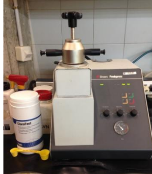
Ilustración 3.12 Máquina de empastillado y metacrilato empleado.
