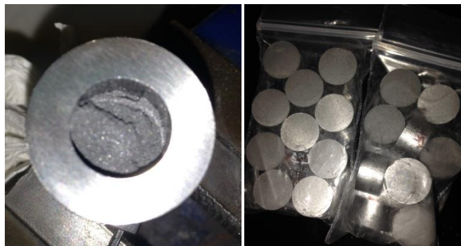
Ilustración 3.6 Muestra de la camisa que contiene el polvo aleado (izquierda) y parte de las probetas obtenidas tras el compactado (derecha).
