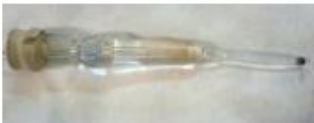
Figura 15. Electrodo de referencia \text{Ag}/\text{AgCl}/\text{KCl} 3 M
