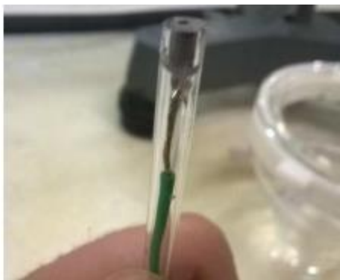
Figura 20. Electrodo de platino donde se puede observar en la parte superior la película de polipirrol deposita de color negro.
