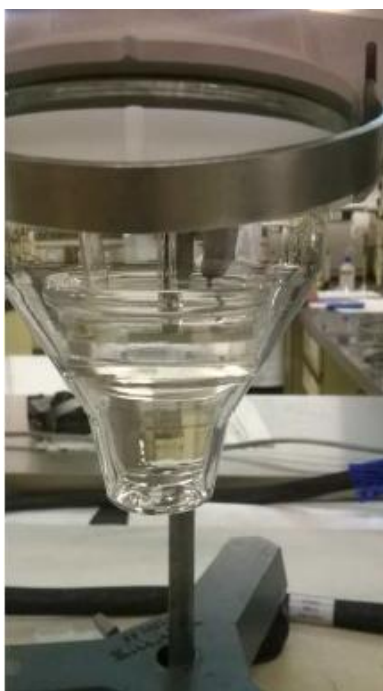
Figura 17. Disposición de los electrodos en el interior de la celda electroquímica.
