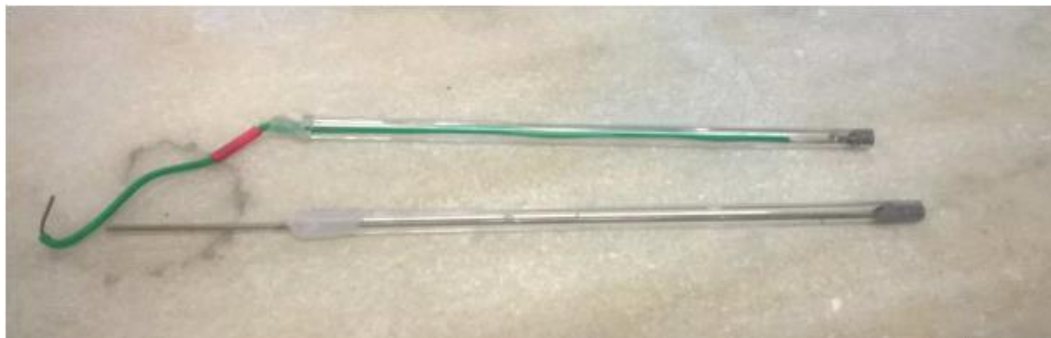
Figura 11. Electroodos de platino y acero inoxidable sellados con Nural.
