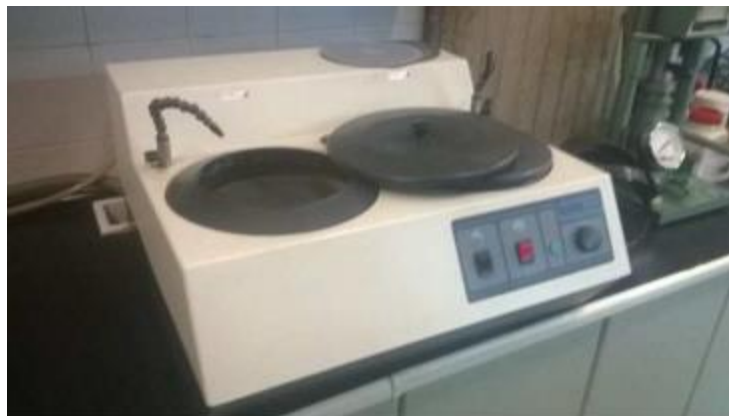
Figura 12. Pulidora empleada en este trabajo para el pulido de los electrodos.
