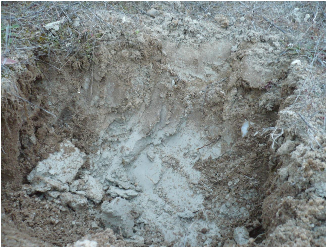
Figura 12. Calicata 2 con horizonte arcilloso próximo a la superficie.
