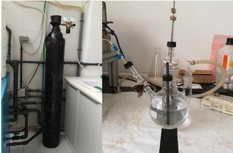
Figura 43: A la izquierda, bombona de N 2 . A la derecha, montaje de la celda con los electrodos.
