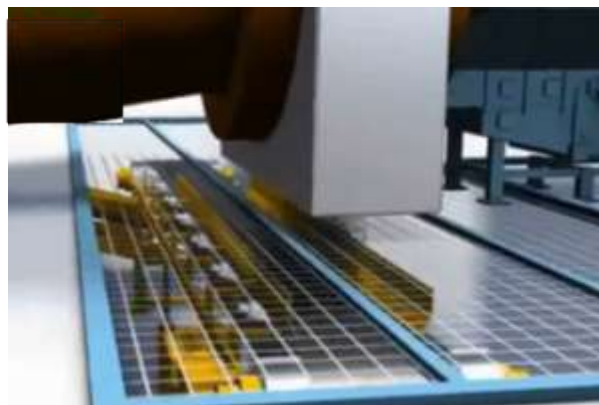
Imagen 8. Tamizador de arena y cinta de transporte a la salida de la machacadora
