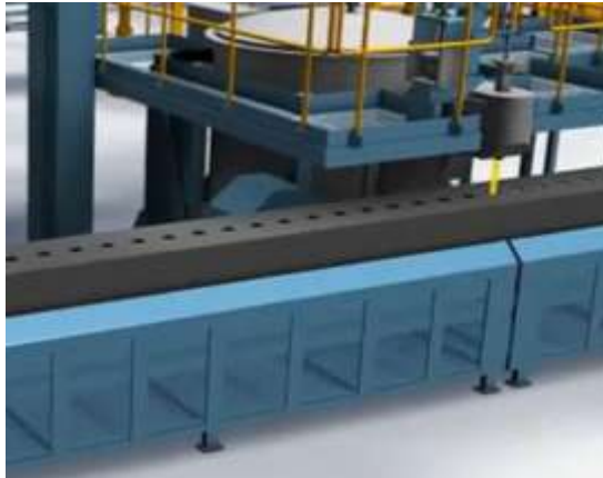
Imagen 13. Detalle del sistema de colada automática en el momento del vertido
