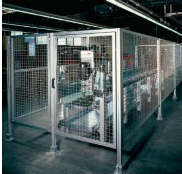
Imagen 27. Resguardos de seguridad
