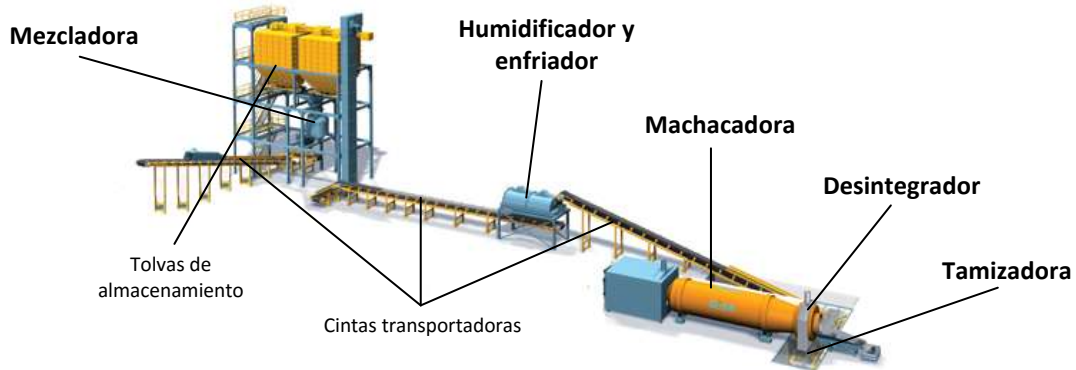
Imagen 5. Esquema de la planta de preparación de las arenas de moldeo
