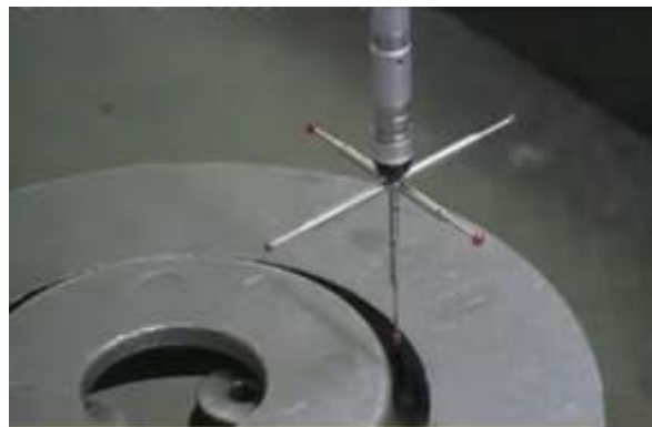
Imagen 17. Detalle de los palpadores de la medidora tridimensional
