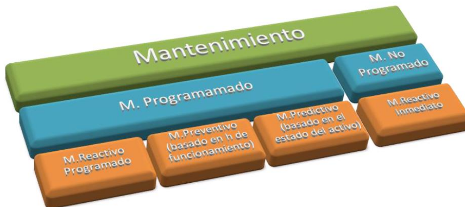
Figura 4.2: Tipos de intervenciones de mantenimiento según se trate de un mantenimiento reactivo, preventivo o predictivo. [Rodríguez Oraá, Bárbara M a . 2013]
