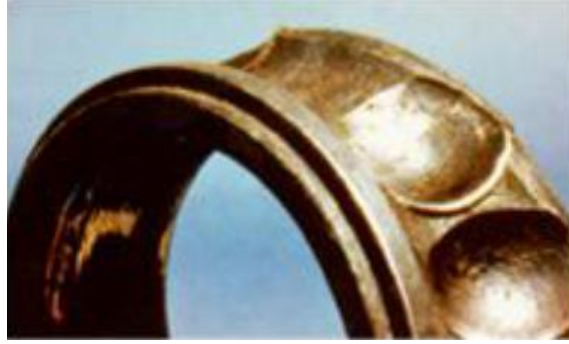
Figura 3.9: Deformación plástica del anillo interior de un rodamiento por sobrecarga. [Alonso Martínez, Alberto. 2015]
