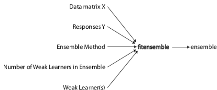
Figura 9.5: Información mínima necesaria para obtener los clasificadores compuestos en MATLAB. [MathWorks 2016]
