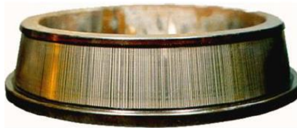
Figura 3.10: Consecuencias de la descarga eléctrica en el anillo interior de un rodamiento. [Alonso Martínez, Alberto. 2015]
