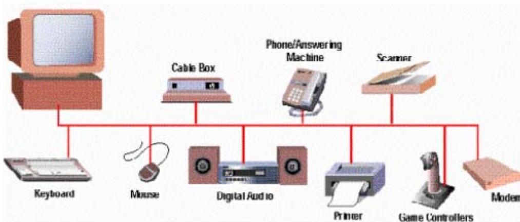
**Figura 28 – Cap.3.4.1: Típicas funciones de un sistema USB**
