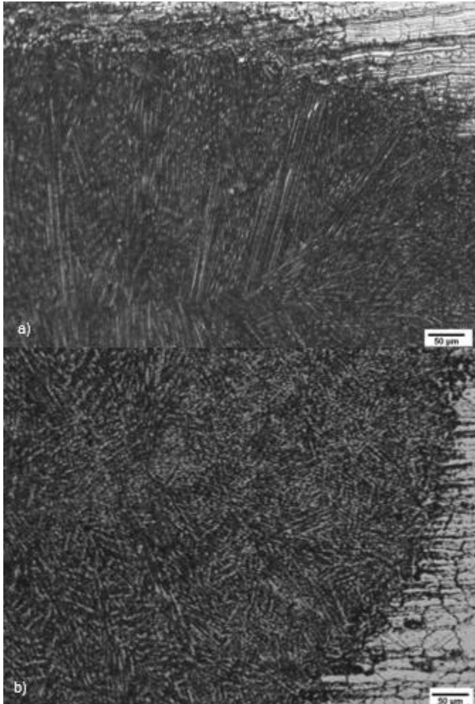
**Fig. 23-** Estructura atacada después de la prueba de ácido oxálico, metal fundido a 100X: a)0,5 h, b)200 h.
