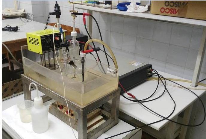
**Fig. 16** – Celdilla electroquímica.
