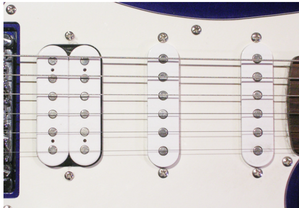
Figura 1.11: Imagen de los imanes frente a las cuerdas de una guitarra eléctrica.
