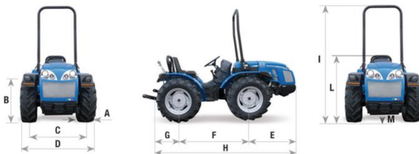
Dimensiones de los tractores Invictus K300 - K400 AR con arco de protección (mm)
