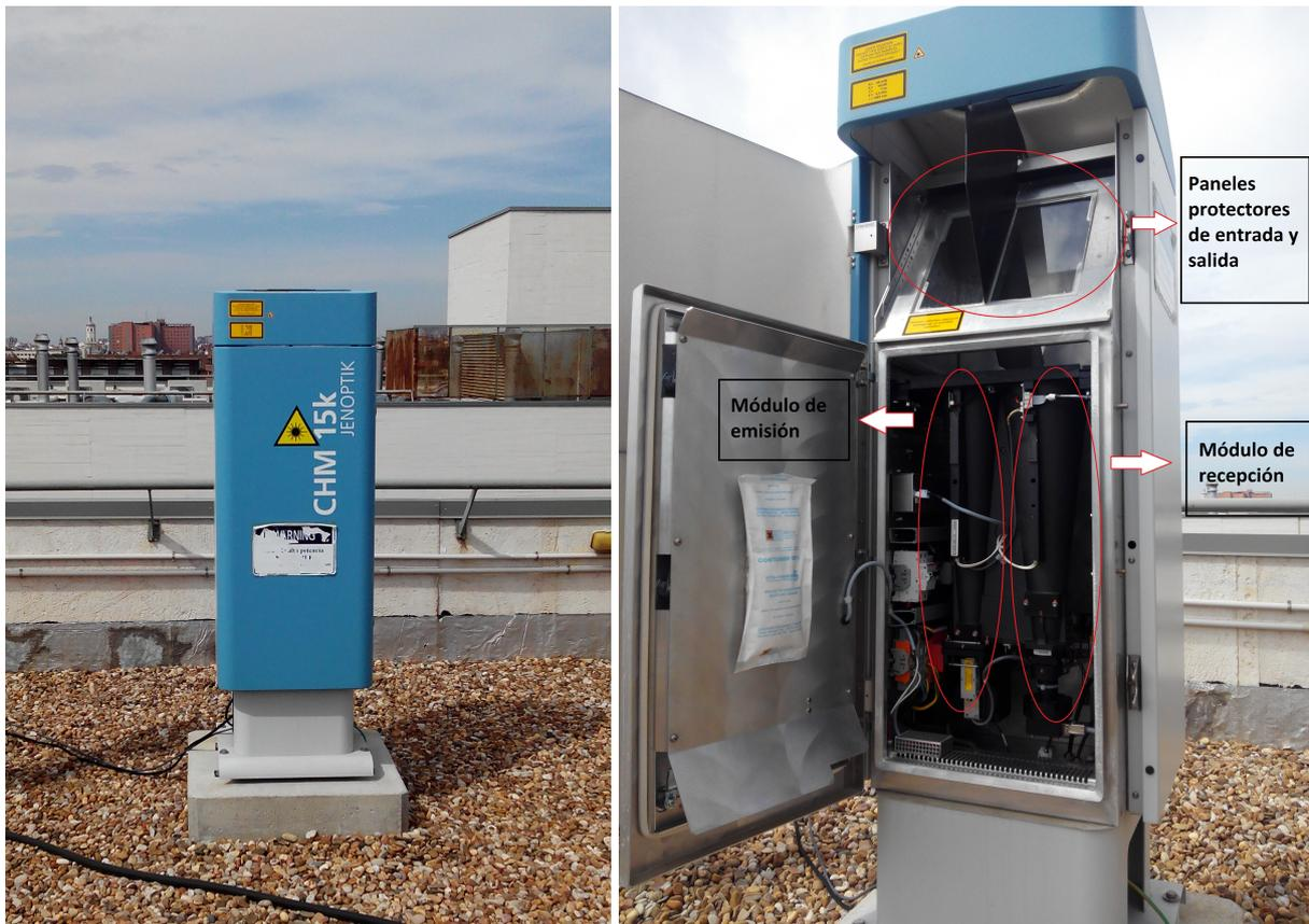
Figura 4.1: Fotografías del ceilómetro en la azotea de la facultad de ciencias.
