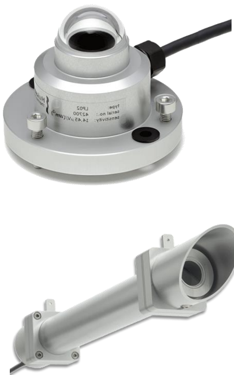
Figura 2.10a Piranómetro (radiación solar global). Figura 2.10b Pirheliómetro (radiación solar directa). Fuente: sensovant.com Figura 2.10c Piranómetro con banda de sombra (radiación solar difusa). Cortesía de la UVA.
