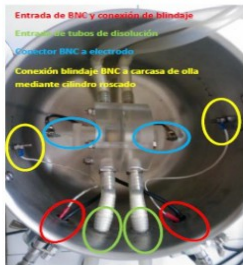
Figura 14.2. Vista interna de entrada de cables y tubos a la olla.
