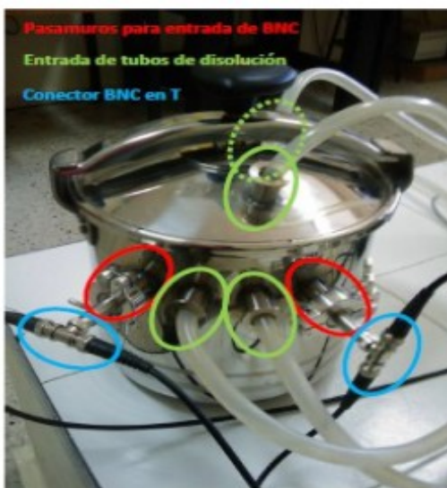
Figura 14.1. Vista externa de entrada de cables y tubos a la olla.
