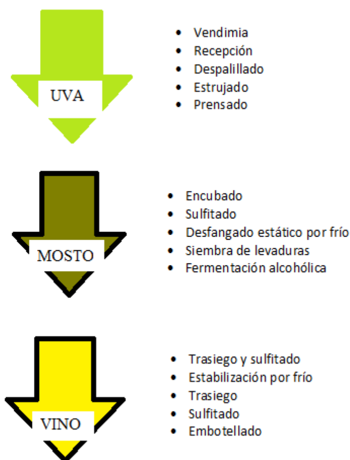
Figura1. Diagrama de flujo del proceso de vinificación realizado.
